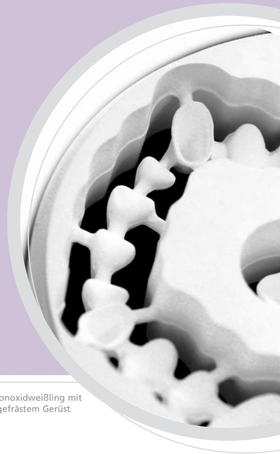
Abb. 1: Zirkonoxidweißling mit ausgefrästem Gerüst
